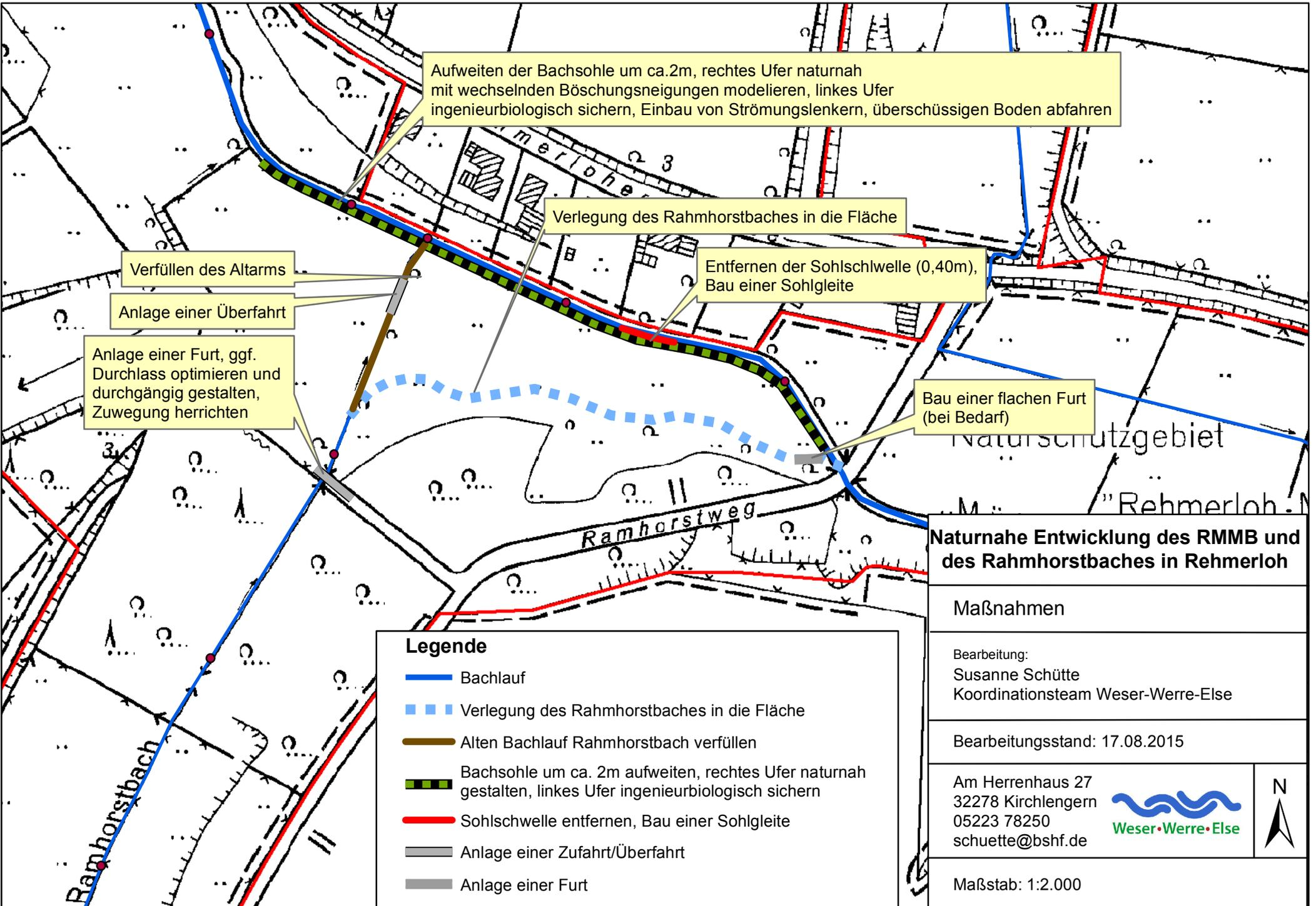
Aufweiten der Bachsohle um ca.2m, rechtes Ufer naturnah mit wechselnden Böschungsneigungen modellieren, linkes Ufer ingenieurbologisch sichern, Einbau von Strömunglenkern, überschüssigen Boden abfahren
